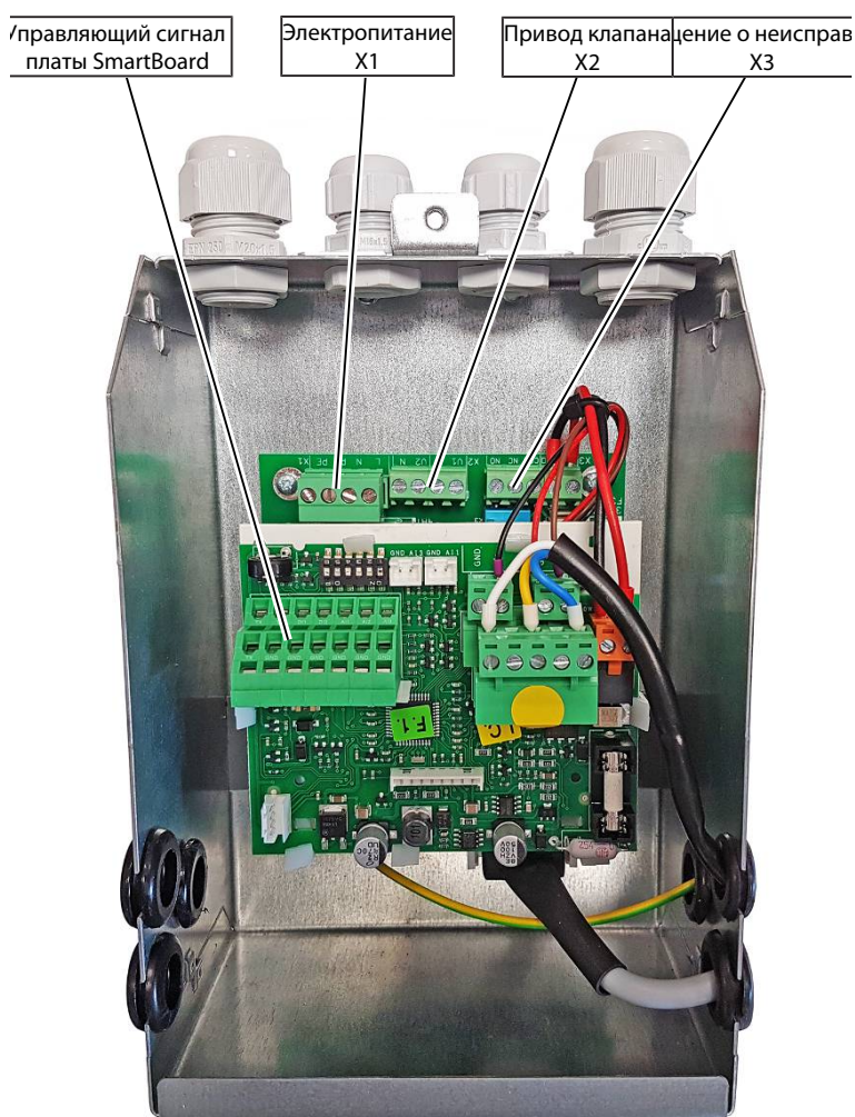
Рис. 27: Плата в электрораспределительной коробке
