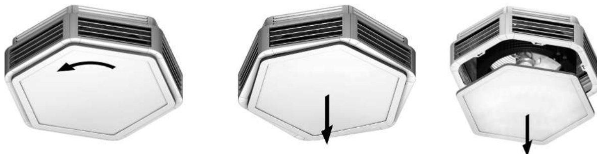
Рис. 32: Демонтаж крышки корпуса
