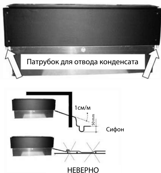
Рис. 39: Правильный отвод конденсата
