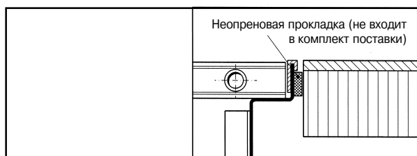
Рис. 10: Установка неопреновых прокладок
