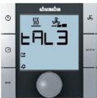
Сообщение «Неисправное отображение часов реального времени KaController»
