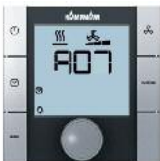
Сообщение «Неисправность двигателя»
