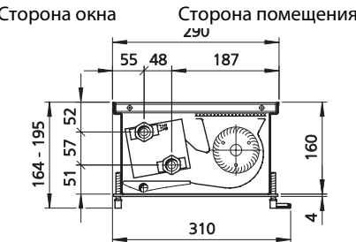
Разрез (охлаждение или обогрев) Пример: Рулонная решетка
