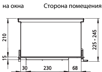
Вид сбоку со встроенным конденсатным насосом
