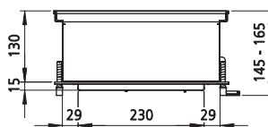
Вид сбоку со встроенным конденсатным насосом
