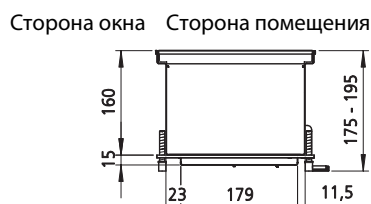
Вид сбоку со встроенным конденсатным насосом
