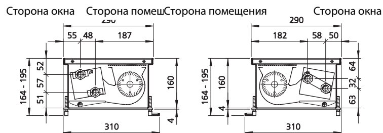
Разрез (охлаждение или обогрев)
