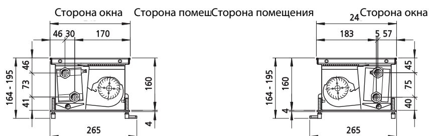
Разрез (охлаждение или обогрев)
