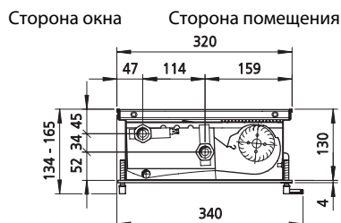
Разрез (охлаждение или обогрев) Пример: Рулонная решетка
