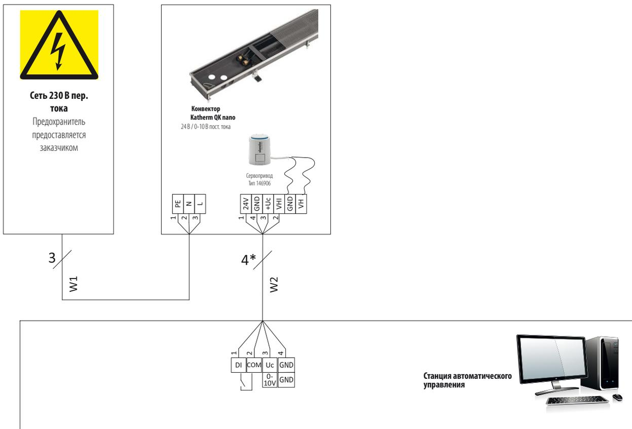
\* Экранированный провод (например, IY(ST)Y, 0,8 мм) прокладывать отдельно от линии электропередачи.
