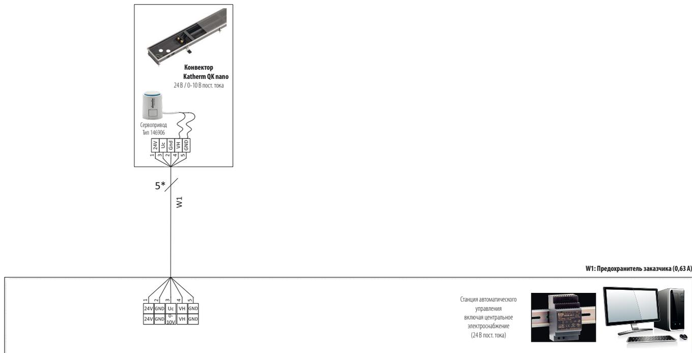
\* Экранированный провод (например, IY(ST)Y, 0,8 мм) прокладывать отдельно от линии электропередачи.
