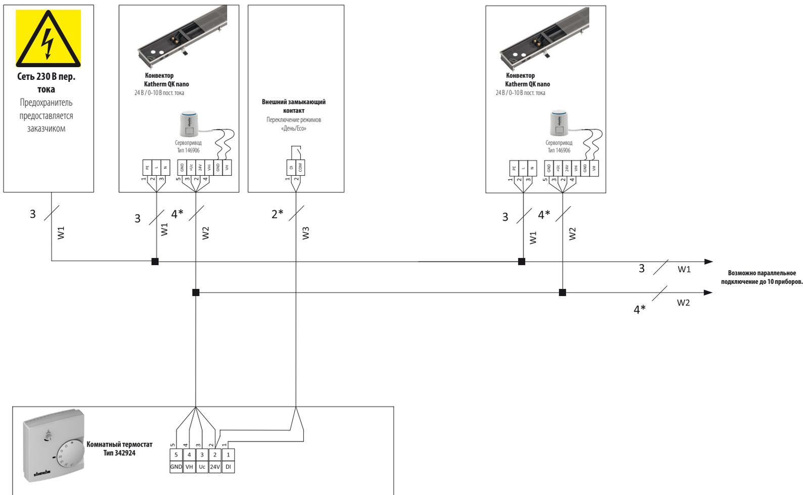
\* Экранированный провод (например, IY(ST)Y, 0,8 мм) прокладывать отдельно от линии электропередачи.
