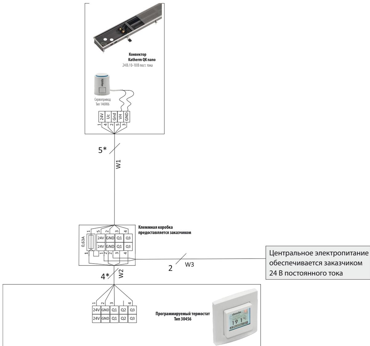
\* Экранированный провод (например, IY(ST)Y, 0,8 мм) прокладывать отдельно от линии электропередачи.
