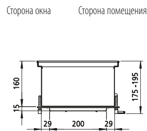
Вид сбоку с установленным кондесатным насосом
