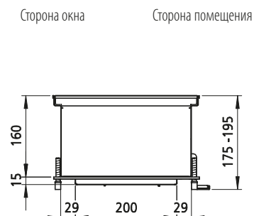
Вид сбоку с установленным конденсатным насосом
