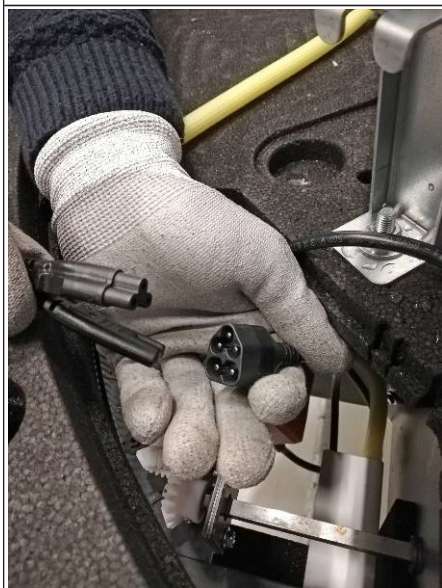
Рис. 32: Отсоединение кабеля
