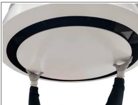
Рис. 27: Снятие крышки корпуса
