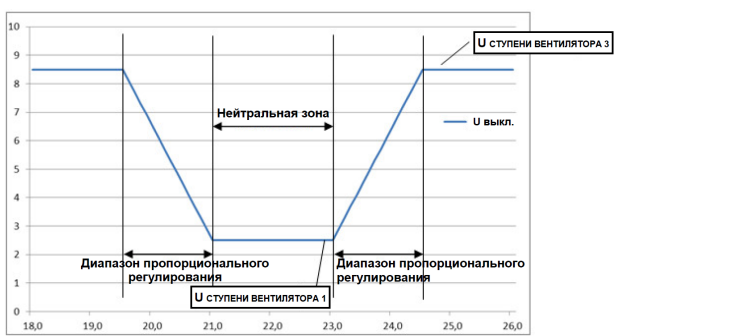
Динамическое управление вентилятором в 4-трубной системе с параметрами по умолчанию и заданной температурой 21°C
