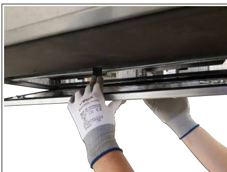
Рис. 52: Надавить на стопорную пластину
