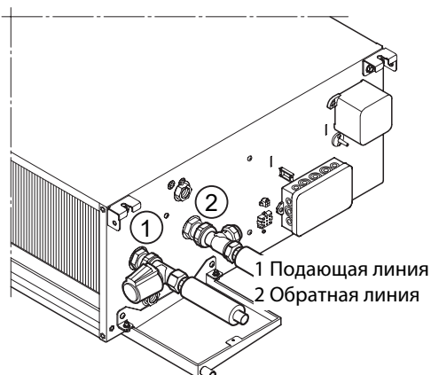
Комплект 2-ходовых клапанов, проходное исполнение, 2-трубное исполнение, подключение
