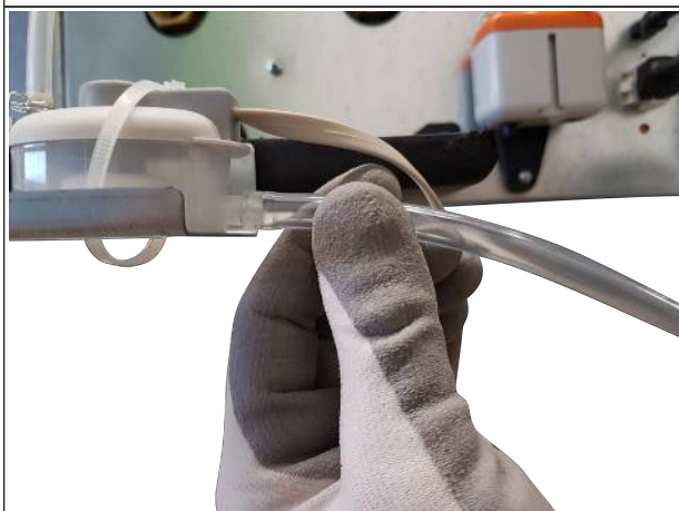
Рис. 27: Подсоединить всасывающий шланг
