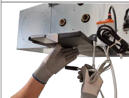
Рис. 61: Отсоединить и удерживать ванну для сбора конденсата
