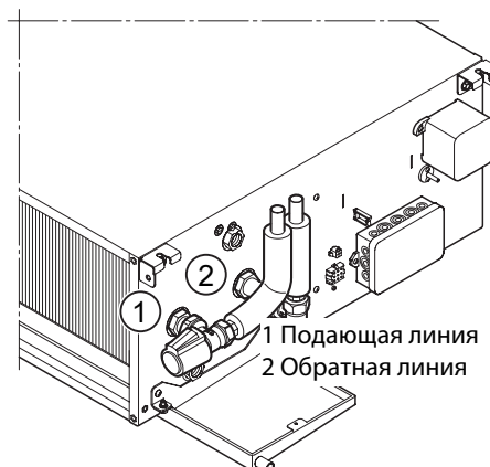
Комплект 2-ходовых клапанов, угловое исполнение, 2-трубное исполнение, подключение
