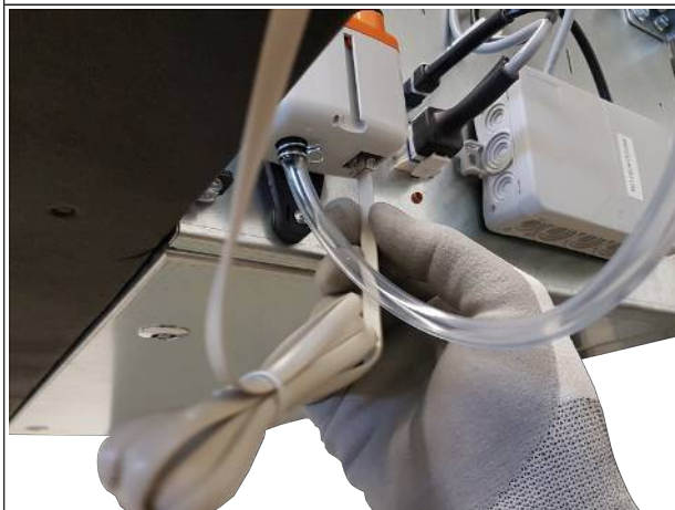
Рис. 29: Вставить кабель сигнализации поплавкового выключателя
