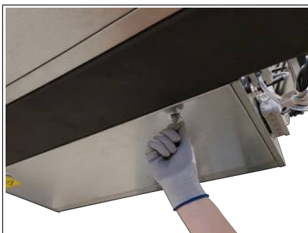
Рис. 50: Открыть поворотный фиксатор
