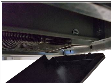
Рис. 64: Установить ванну для сбора конденсата
