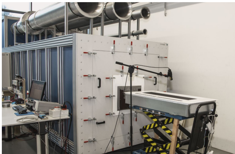
Испытательная камера для измерения производительности по воздуху; Kampmann F&E Center
